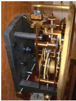
Abb. xxxix (r.) Riefler-Uhr 031 B / FH 1897/1898 (mit späterem Hauptwerk vom Typ I und schwerer Späterwerk) Gussstein aus guss.stm.de mit Horizontal- und Vertikal-Lage durch die Zweier-Befestigungs-lösung (ab 1896/97 bis etwa 1907)
